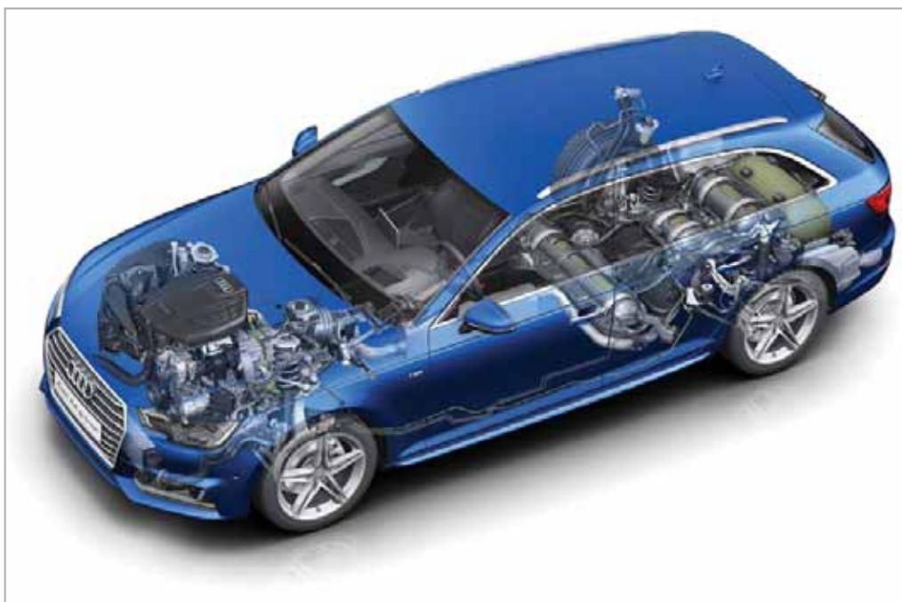
Рис. 6. Схема размещения баллонов на Audi A4
