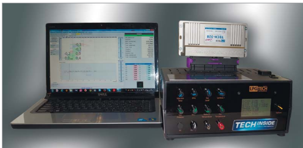
Рис. 1. Имитатор с подключенным ЭБУ газа и компьютером
