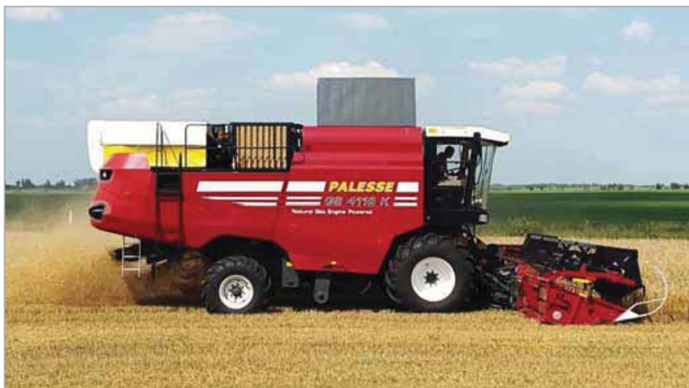
Самоходный зерноуборочный комбайн GS4118K на газомоторном топливе
