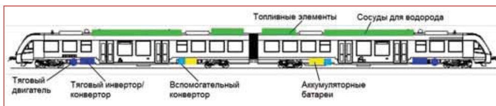
Схема расположения узлов в водородной электричке
