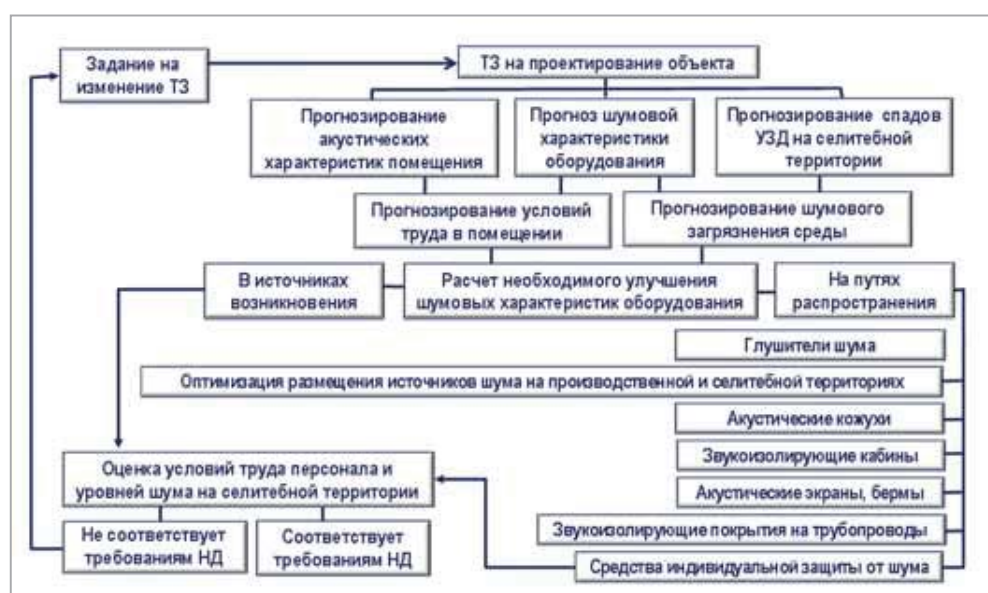
Рис. 2. Алгоритм разработки мероприятий по снижению шума
