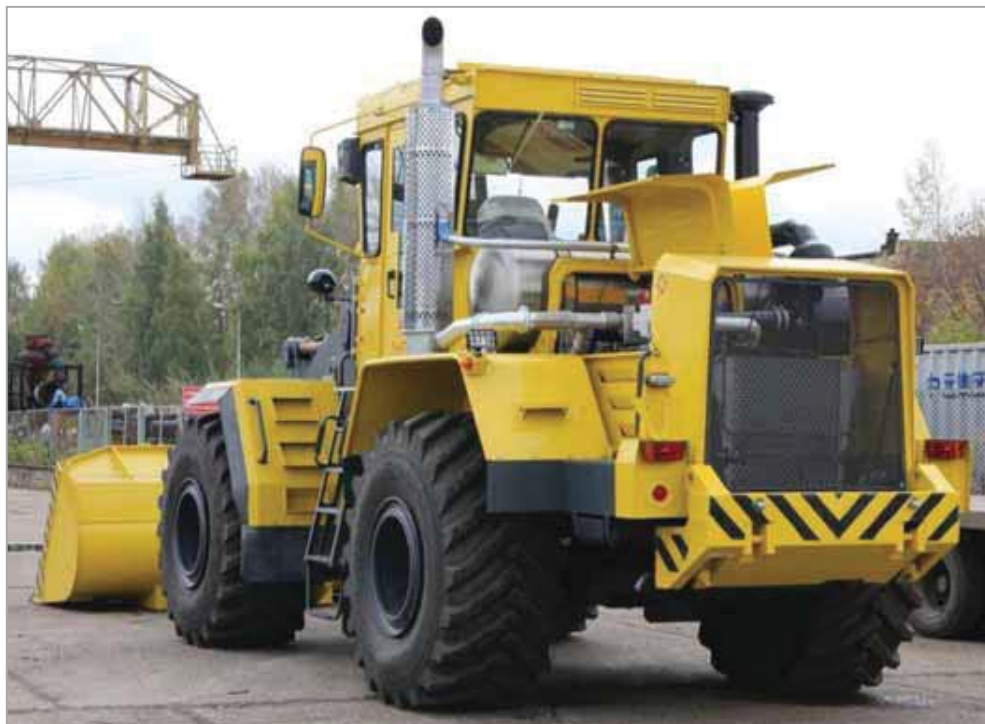
Трактор К-702 с двигателем RGK производства «РариТЭК»
