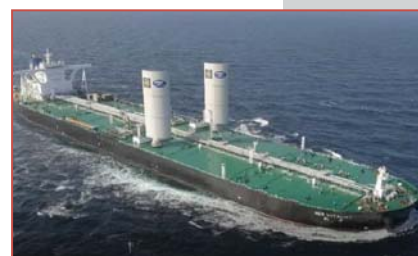
Танкер New Vitality с турбопарусами
