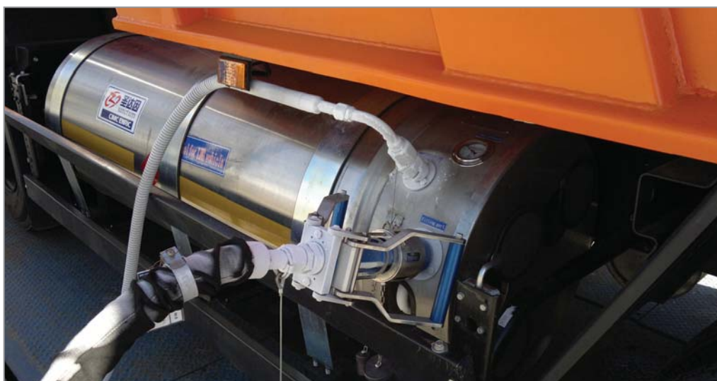
Рис. 1. Заправка опытного самосвала КАМАЗ, оборудованного криобаком для СПГ
