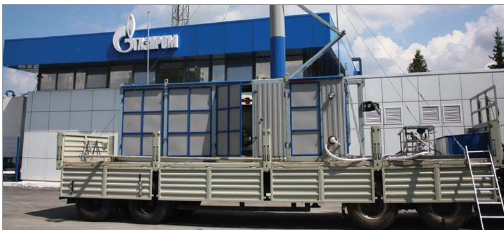
Рис. 5. Активный мобильный регазификатор СПГ РПМ 2000
