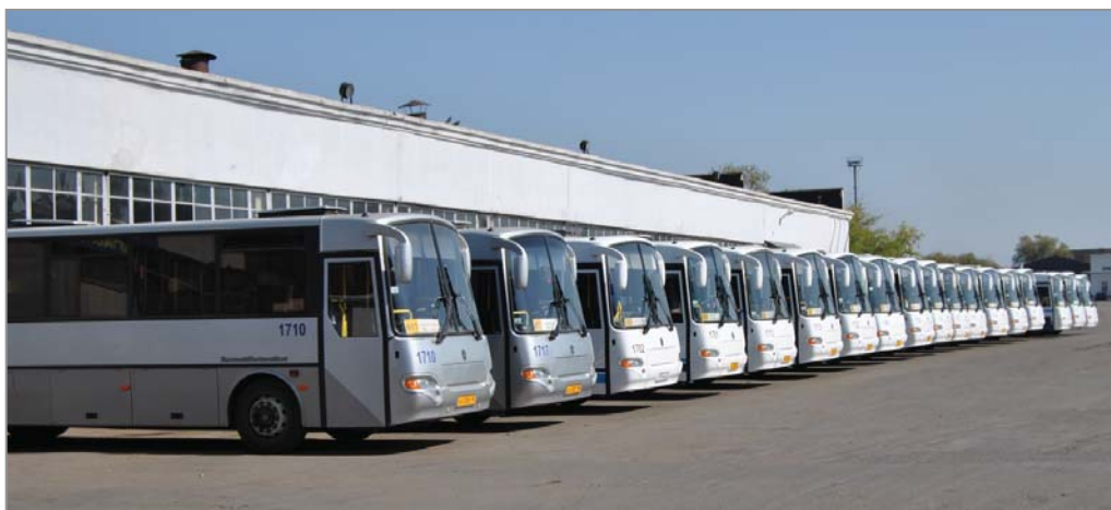
Автобусы ЗАО «АК № 1825», работающие по газодизельному циклу
