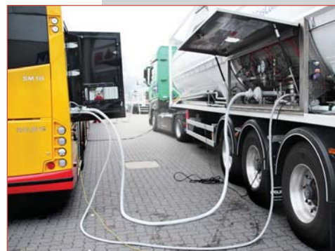
Заправка автобуса Solbus сжиженным метаном
