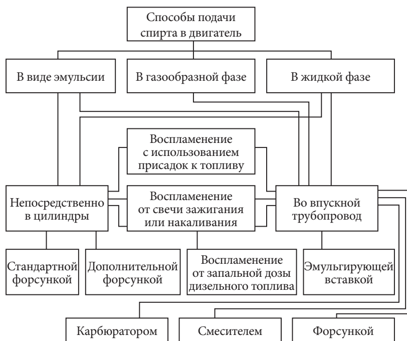
Рис. 1. Способы подачи и воспламенения этанола в дизельных двигателях
