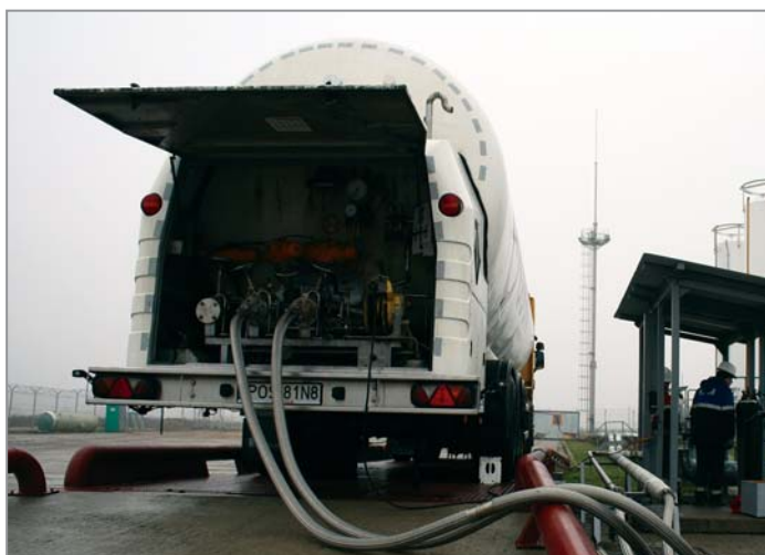
Заправка метановоза сжиженным природным газом в Калининградском филиале ООО «Газпром газомоторное топливо»
