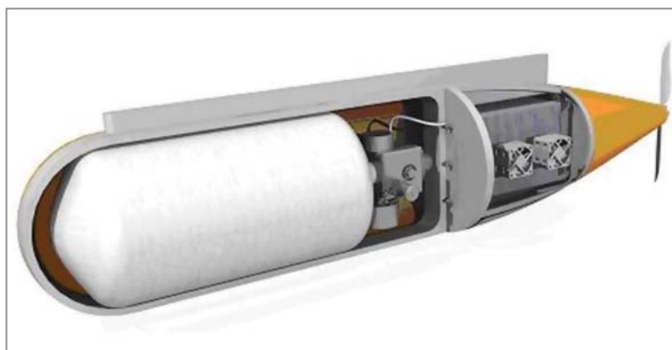
Рис. 6. Внешний вид беспилотного аппарата I-401 В (а) и гондола в разрезе (б)
