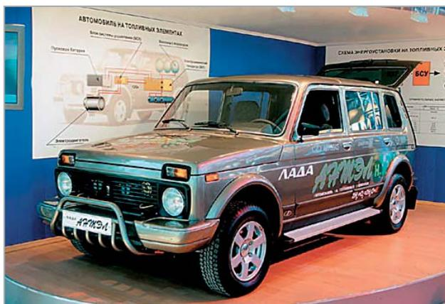
Рис. 7. Электромобиль «Лада АНТЭЛ-1» (АНТЭЛ – автомобиль на топливных элементах)
