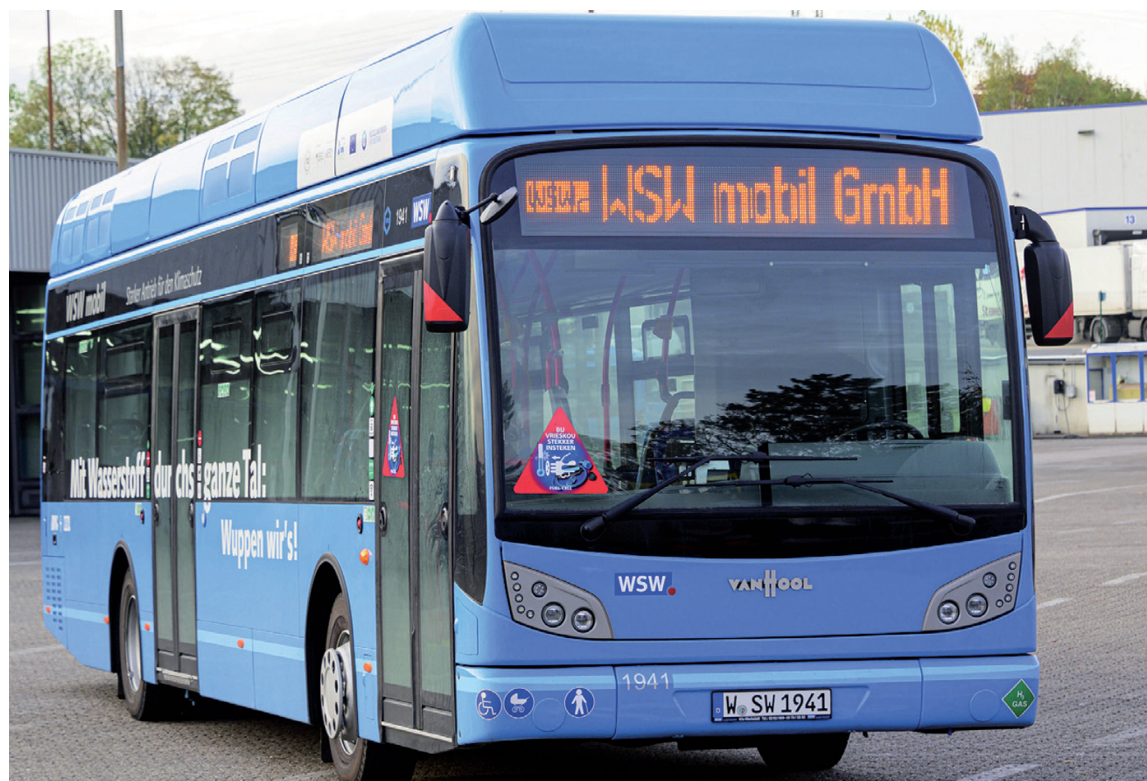
Водородные автобусы с бортовыми системами заправки Worthington Industries
