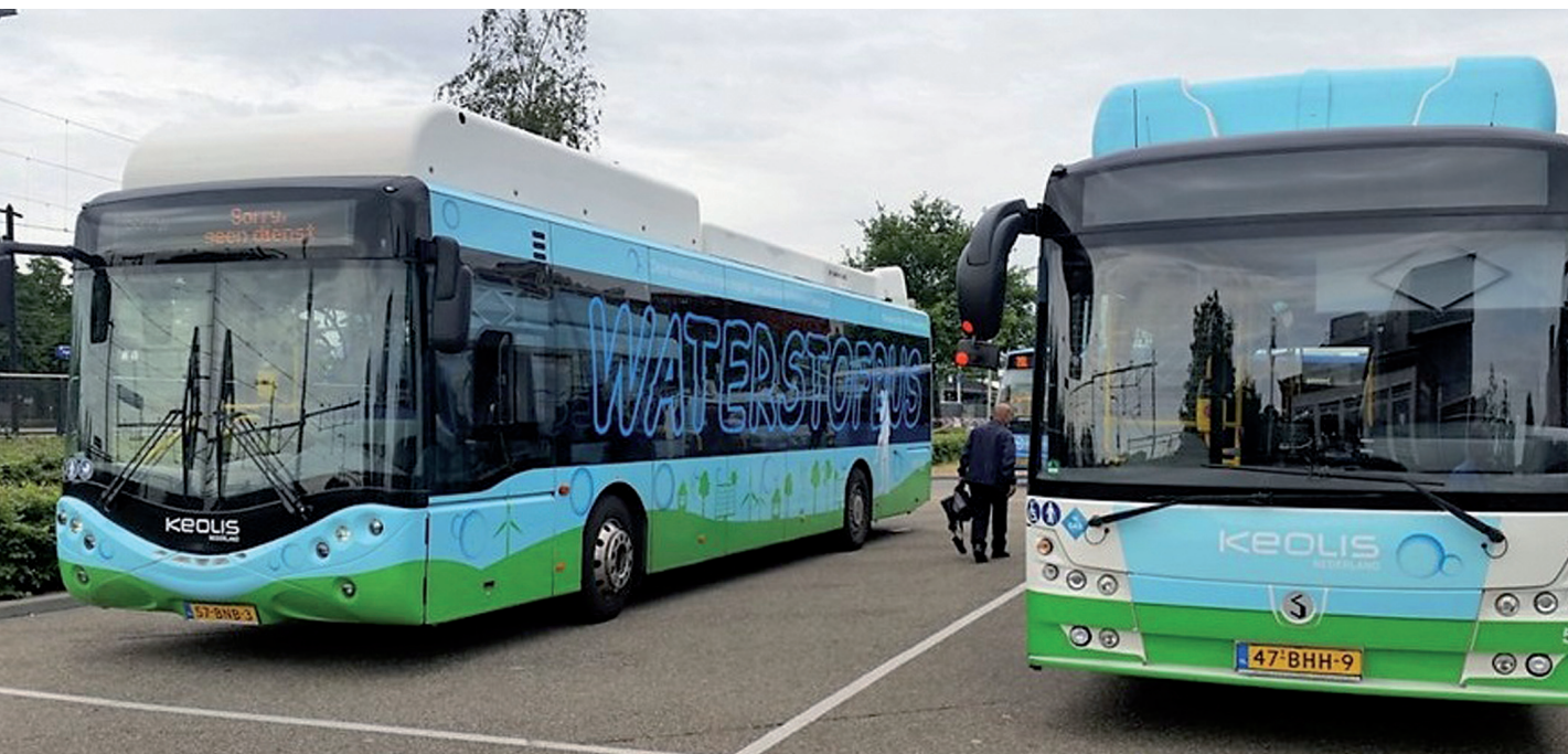
Автобусы на водородных топливных элементах HyMove на станции Апельдорн в Гелдерланде (Нидерланды). Автобус слева оснащён бортовыми заправочными системами Worthington
