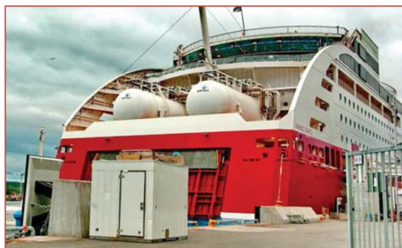
На корме парома Viking Grace установлены две емкости для СПГ, запаса которого хватает на полный оборотный рейс
