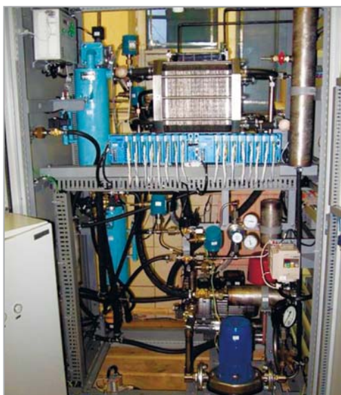
Рис. 6. Батарея топливных элементов (вверху) и энергоустановка электрической мощностью 10 кВт, разработанная РНЦ «Курчатовский институт» совместно с ЦНИИ СЭТ
