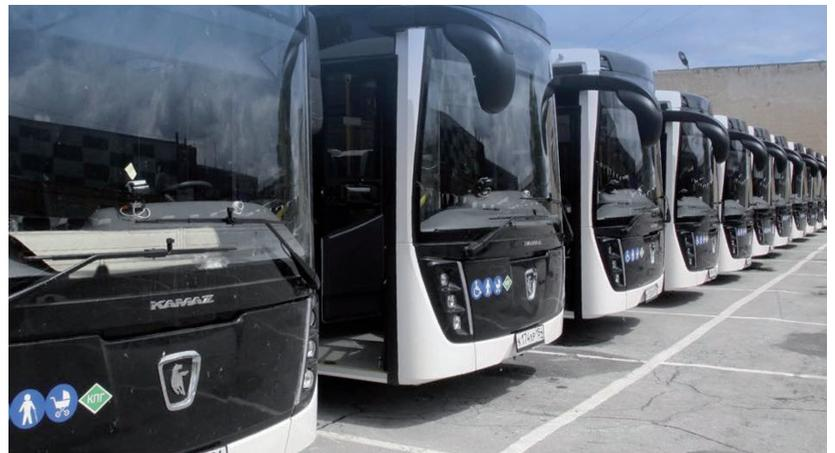
Новые НЕФАЗы рассчитаны на 110 мест. У автобусов установлены системы навигации, видеонаблюдения, контроля за поведением водителя, салон также приспособлен для маломобильных пассажиров. Транспорт приспособлен к зиме: на окнах стоят двойные стеклопакеты, а на полу – теплоизоляция.
