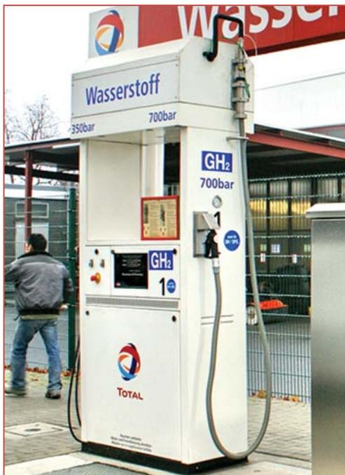
Станция заправки автомобилей компримированным водородом в Германии
