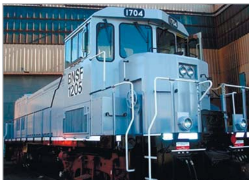
Рис. 7. Прототип локомотива fuelcell-hybrid switcher; справа – схема хранения водорода на борту локомотива
