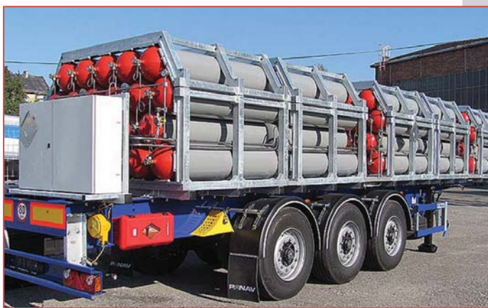
ПАГЗ Vitkovice: вместимость 2500...5200 м 3 ; давление до 30 МПа; рабочие температуры от –20 до +65 °С (от –40 °С по специальному заказу)
