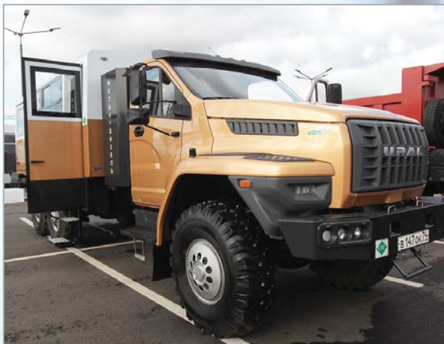
Урал Next; блок заправки КПП для АЗС
