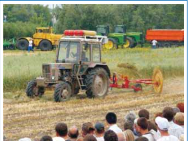
Рис. 12. Трактор «Беларусь», переоборудованный на КПГ
