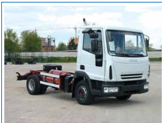
Рис. 8. Eurocargo на КПГ (заводского изготовления)
