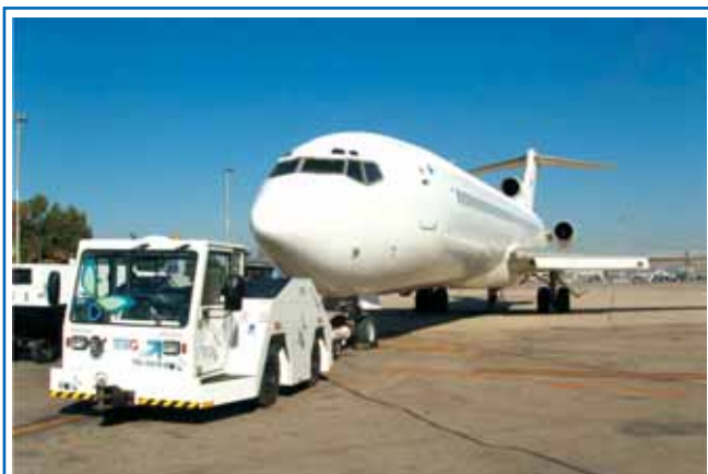
Рис. 18. Транспортировка воздушного судна аэродромным автотягачом на КПГ, созданным по проекту AERGAS
