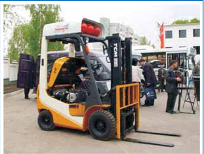
Рис. 11. Вилочный погрузчик, переоборудованный на КПГ
