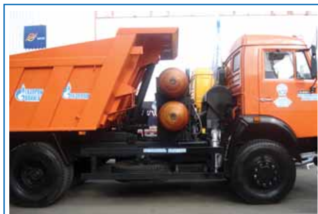
Рис. 7. КамАЗ 65116-40 на КПГ (заводского изготовления, дальность пробега без заправки – 560 км)
