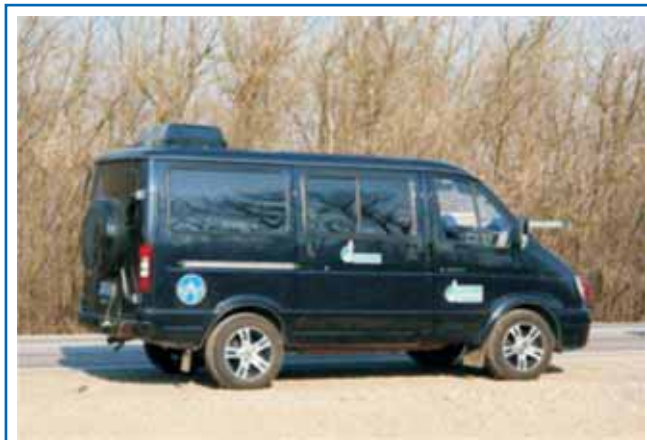
Рис. 14. Двухтопливный автомобиль на природном газе и водороде
