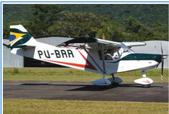
Рис. 19. Ультралегкий самолет Bravo 700 с авиадвигателем на КПГ
