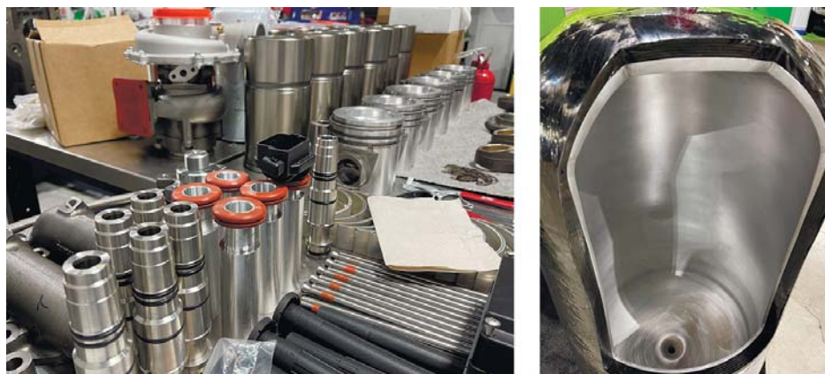
Фото слева: усиленные компоненты цилиндропоршневой группы, используемые для конвертации дизельного двигателя на газ; справа – разрез баллона КПГ 3-го типа показывает надёжность и безопасность конструкции
