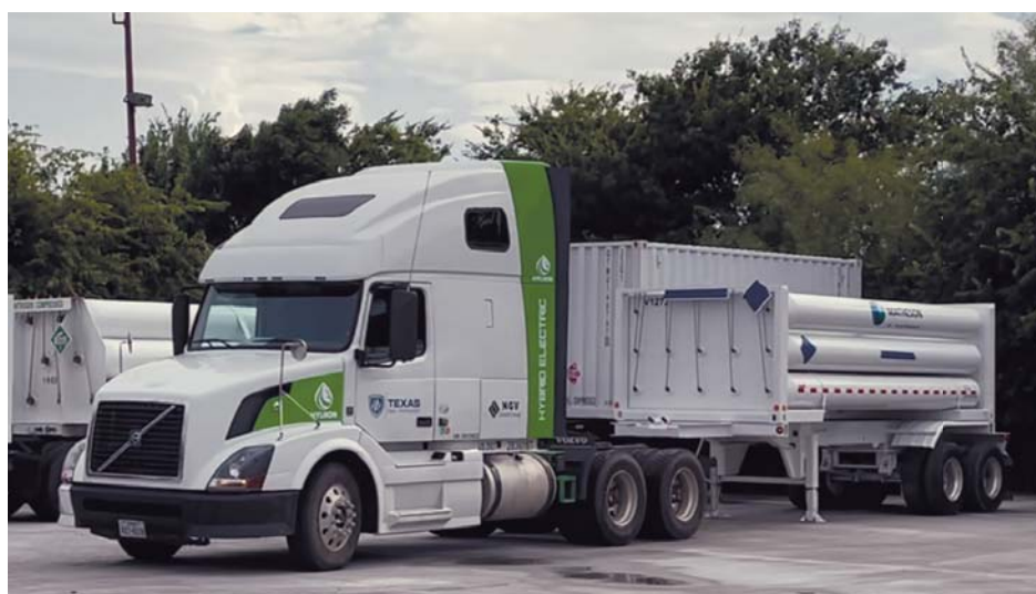
Гибридный тягач для транспортировки КПП, СПГ, водорода и жидкой углекислоты
