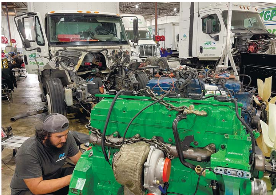
Замена дизельного двигателя на газовый с возможностью работы на КПГ или СПГ
