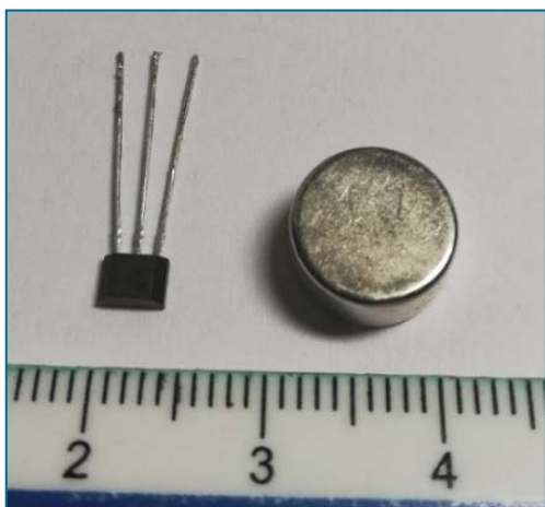
Рис. 3. Аналоговый датчик Холла и неодимовый магнит
