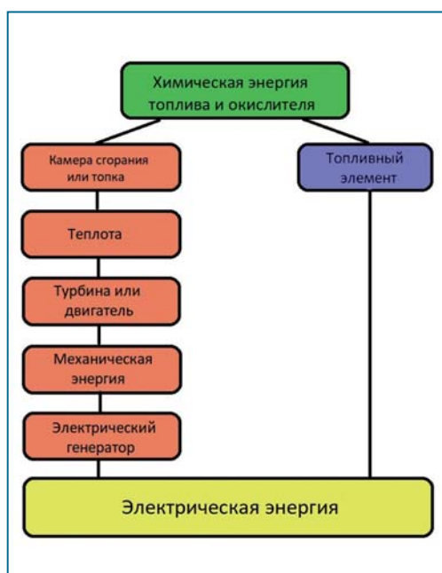
Рис. 1. Ступени преобразования энергии углеводородного и водородного топлив в электрическую энергию
