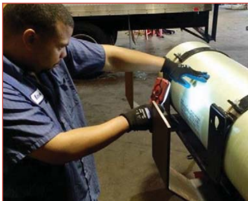
Осмотр газового баллона в США
