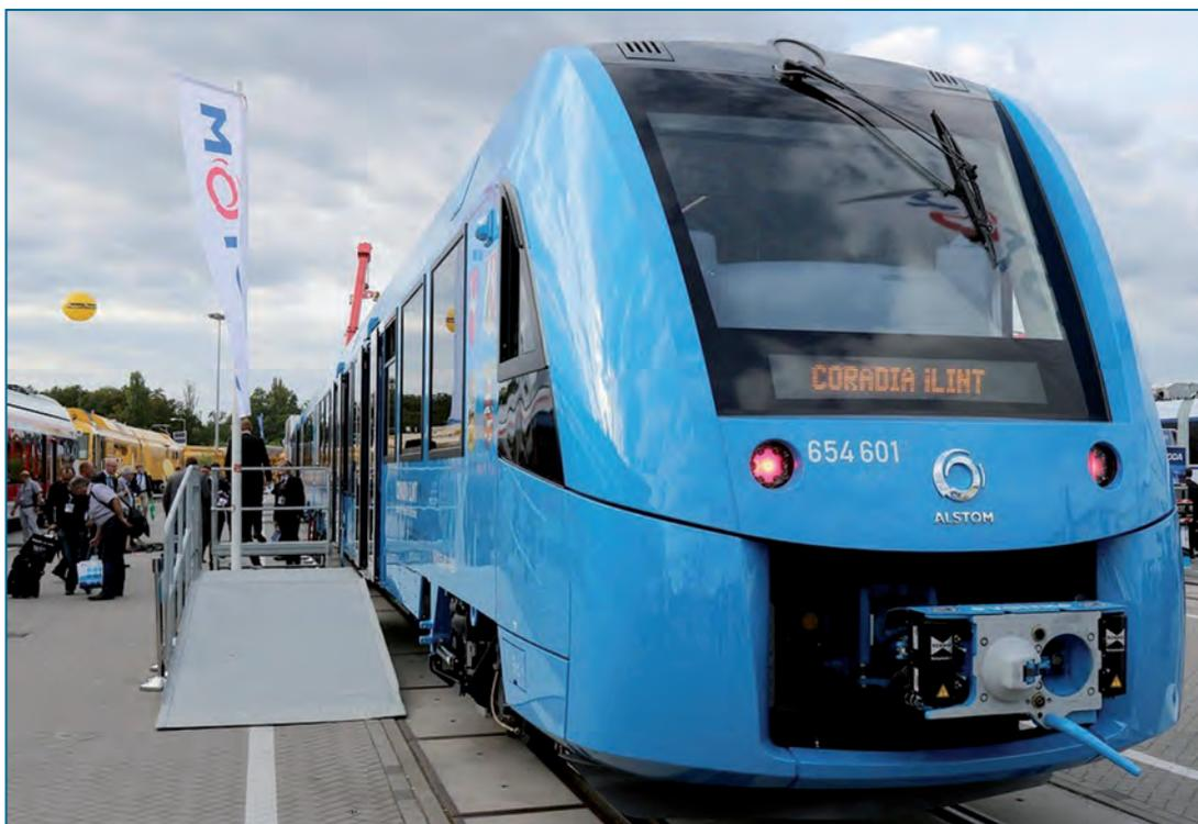
Рис. 2. Corradia iLint, разработанный французской Alstom, – первый пассажирский поезд на водородных топливных элементах, запущенный в серийное производство
